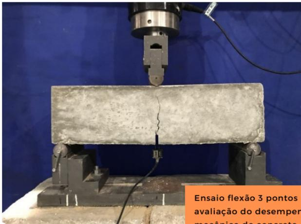
Ensaio flexão 3 pontos para
