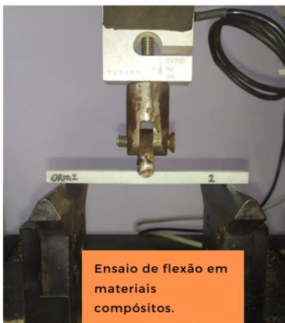
Ensaio de flexão em materiais compósitos.
