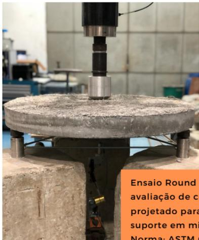
Ensaio Round Panel para avaliação de concreto projetado para estrutura de suporte em minas.
