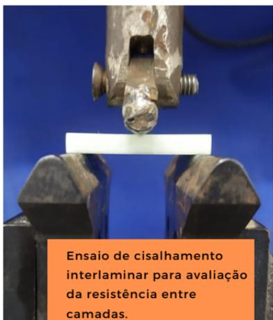
Ensaio de cisalhamento interlaminar para avaliação da resistência entre camadas.
