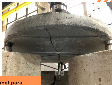
Ensaio Round Panel para avaliação de concreto projetado para estrutura de suporte em minas. Norma: ASTM C 1550
